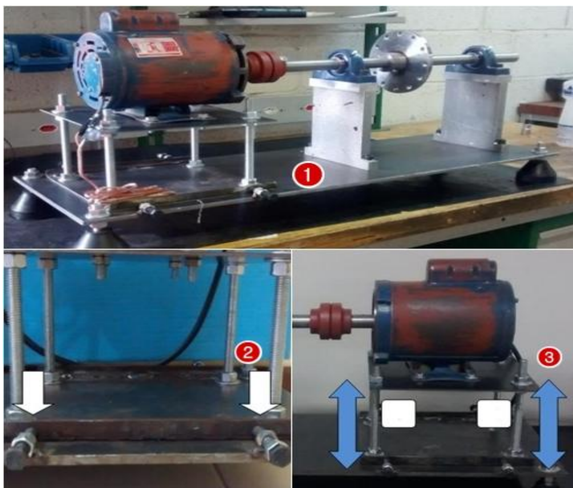
Figura 6 - Bancada didática de vibrações (1) e dispositivos para regulagem de desalinhamento horizontal (2) e vertical (3).
