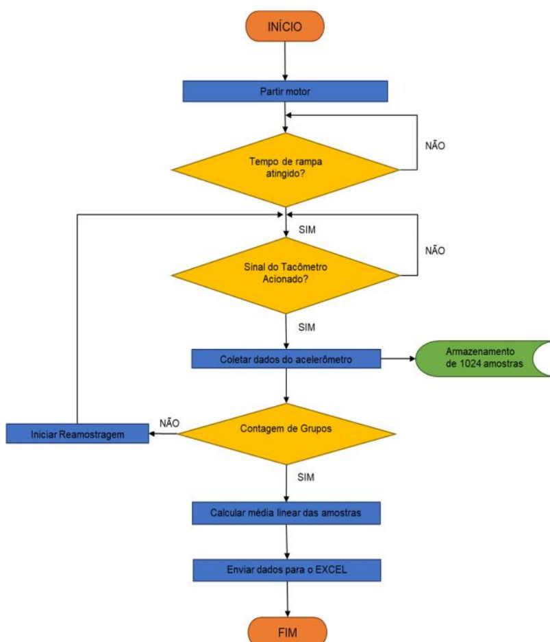
Figura 23 – Algoritmo de controle aplicado no processo de coleta de dados
