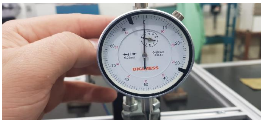
Figura 34 - Leitura do relógio na posição 12h ou 0^\circ
