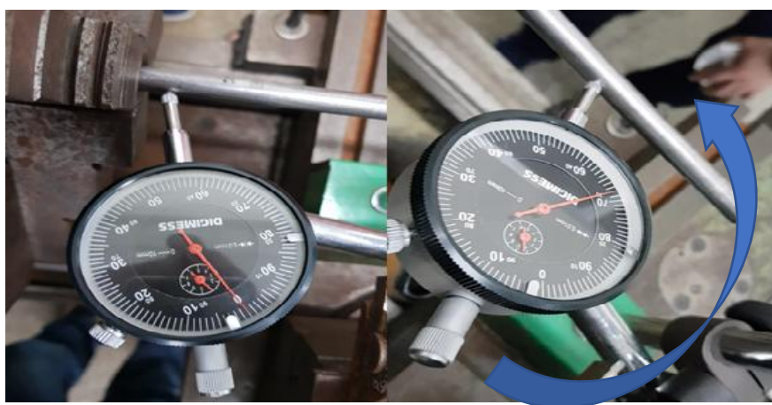
Figura 30 - Verificação do empeno de eixo.
