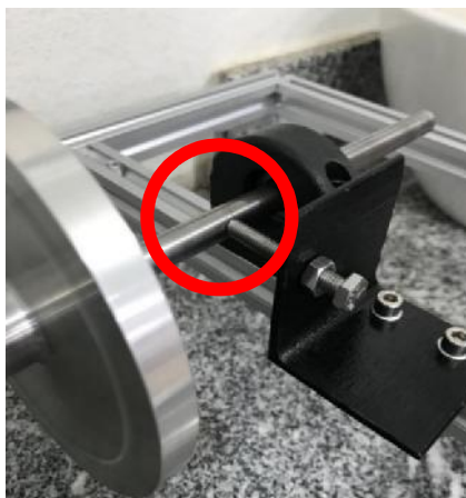
Figura 29 – Dispositivo de roçamento e ponto de contato com o eixo principal.
