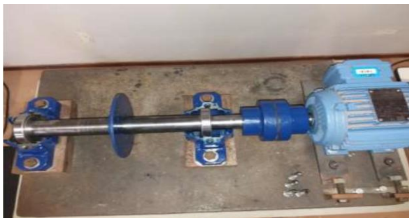
Figura 7 – Aparato experimental: Bancada didática simuladora de vibrações.
